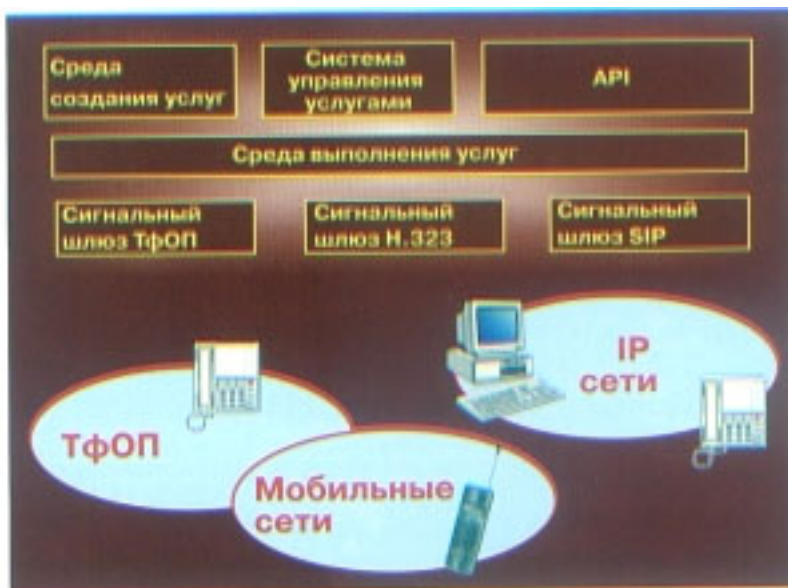
Рис. 1. Архитектура узла услуг
