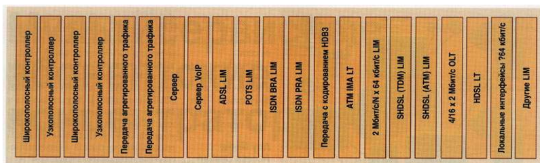
Рис. 2. Мультисервисная линейная полка Litespan 1540.
