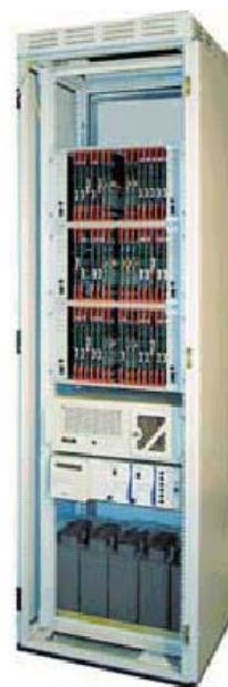
Рис.3 Типовое размещение модулей УПАТС «Оникс» в стативе
