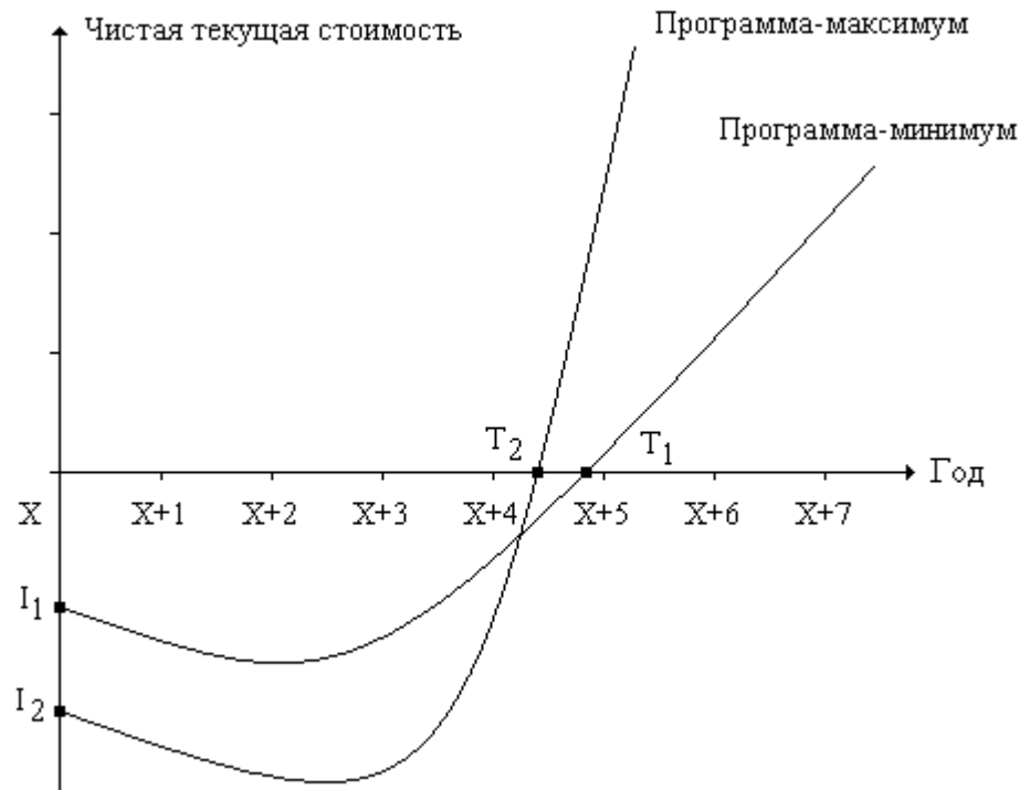
Рис. 6. Кривые NPV для двух вариантов цифровизации ГТС
