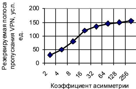
Рис. 6. Зависимость резервируемой полосы пропускания VPN от величины коэффициента симметрии трафика
