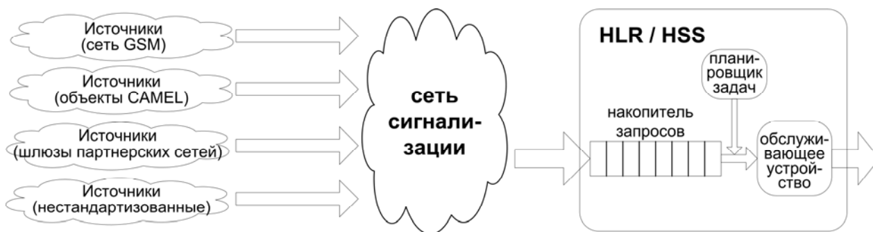
Рис. 1. Функциональная схема организации взаимодействия источников запросов с регистром HLR/HSS
